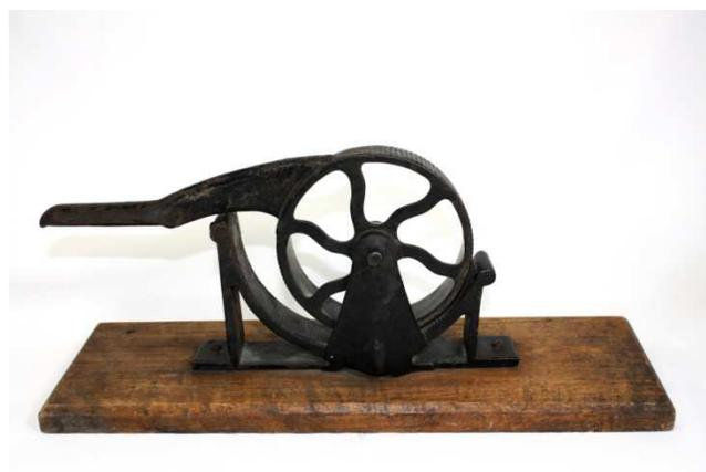
*Machine servant à ramollir les bouchons de liège, fin XIX<sup>e</sup>*
